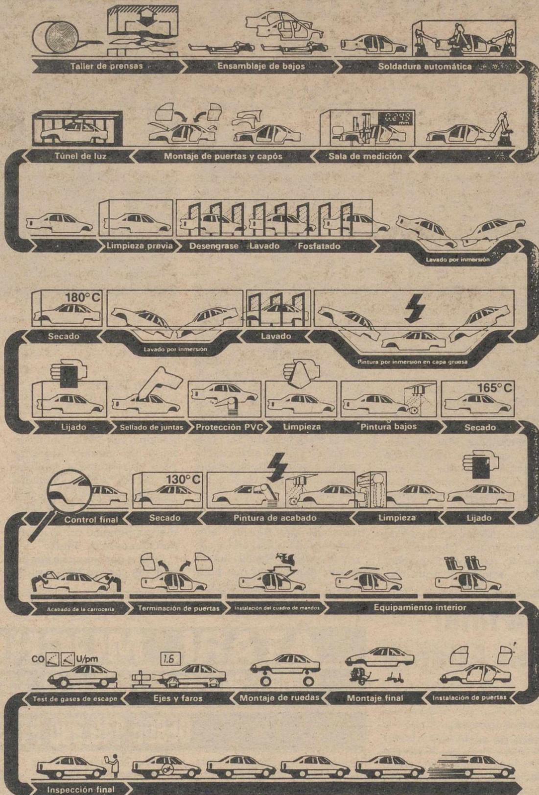
Todo el avanzadísimo proceso de producción del Opel Omega paso a paso.
