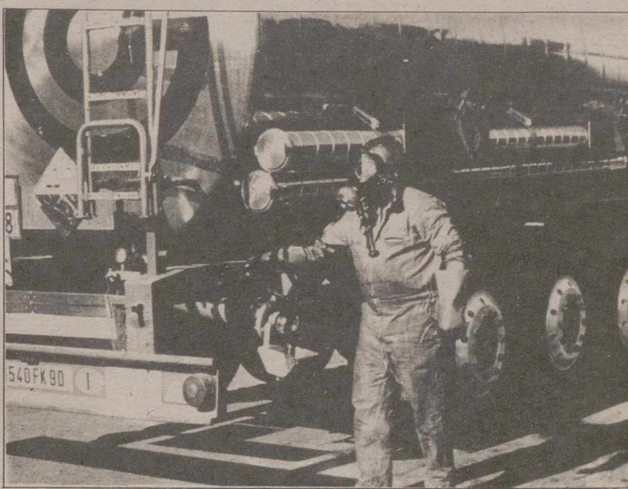
Trajes especiales y equipos de respiración autónoma fueron empleados en el trasvase.
