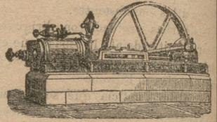
Máquina de vapor fija horizontal.
