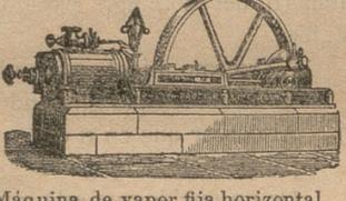
Máquina de vapor fija horizontal.
