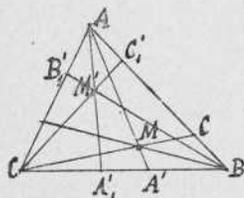
El punto recíproco está definido por la construcción siguiente: AM corta á CB en A'. Sea A'\_1 simétrico de A' con relación al medio de BC. AA'\_1 contiene á M'
