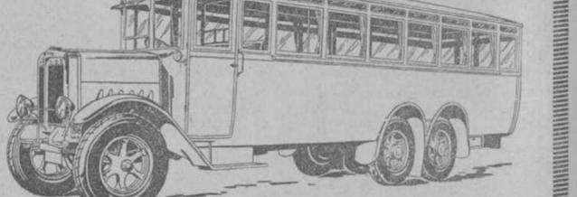
Omnibus especiales con 6 ruedas, 2 diferenciales independientes. Motores de 6 cilindros, 2 carburadores, bloques desmontables, freno motor y radiador con núcleos desmontables. Capacidad de 30 a 60 asientos.
