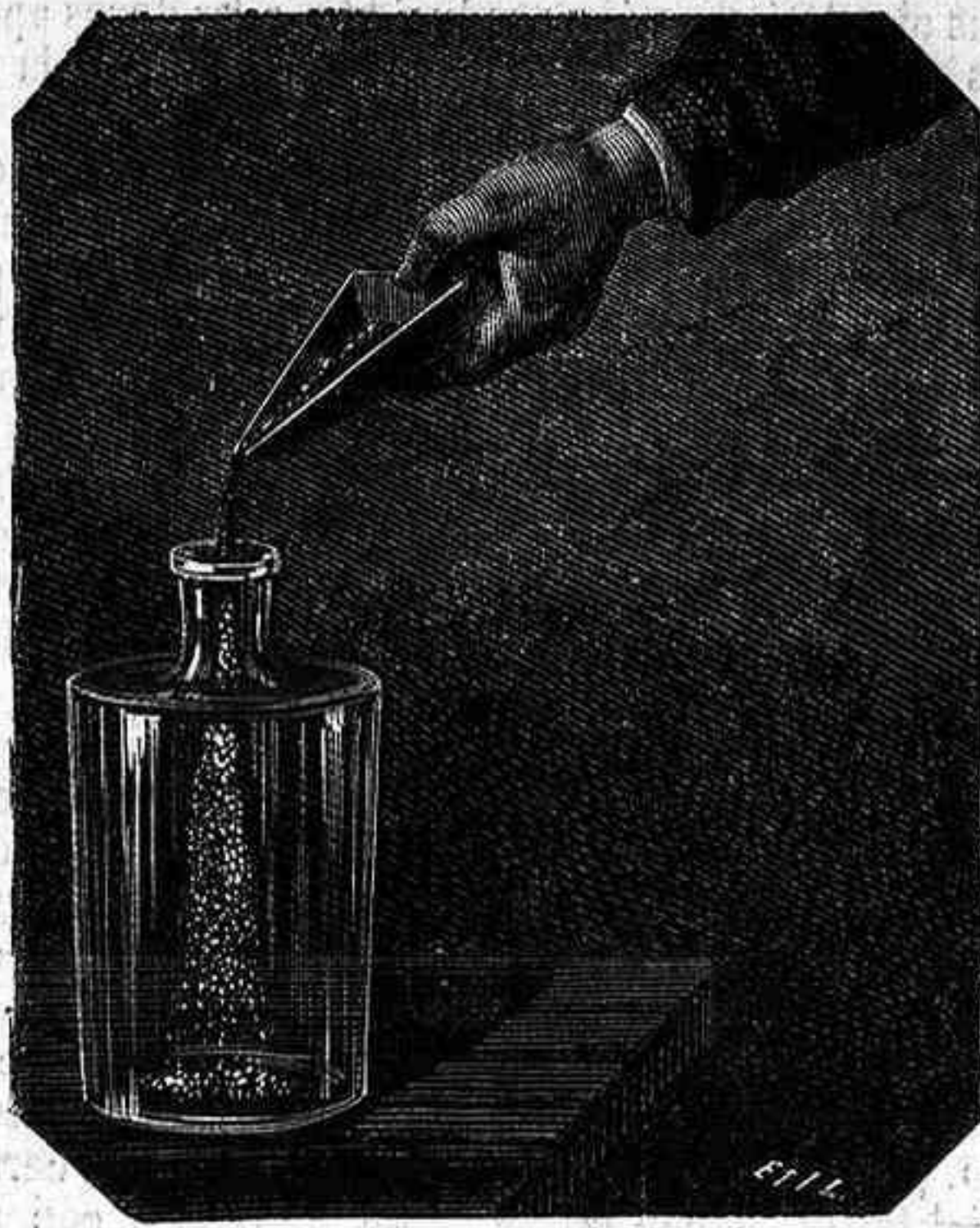
FIG. 2.—COMBUSTION DEL POLVO DE MAGNESIO EN EL OXIGENO.
