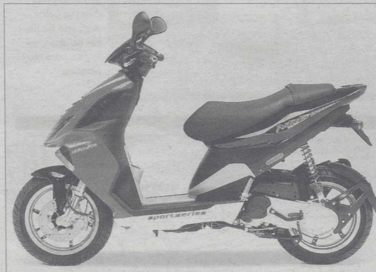
MUY ESTABLE. El chasis es de doble cuna y la horquilla delantera invertida.
