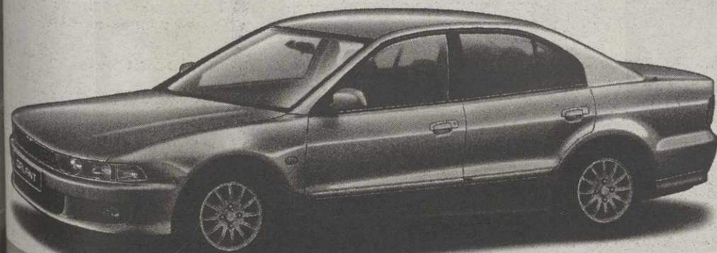
Motores: 2.0 16v y 136 cv, 2.4 GDI (inyección directa de gasolina) y 150 cv, 2.5 V6-24 y 163 cv o Turbo Diesel Intercooler.
