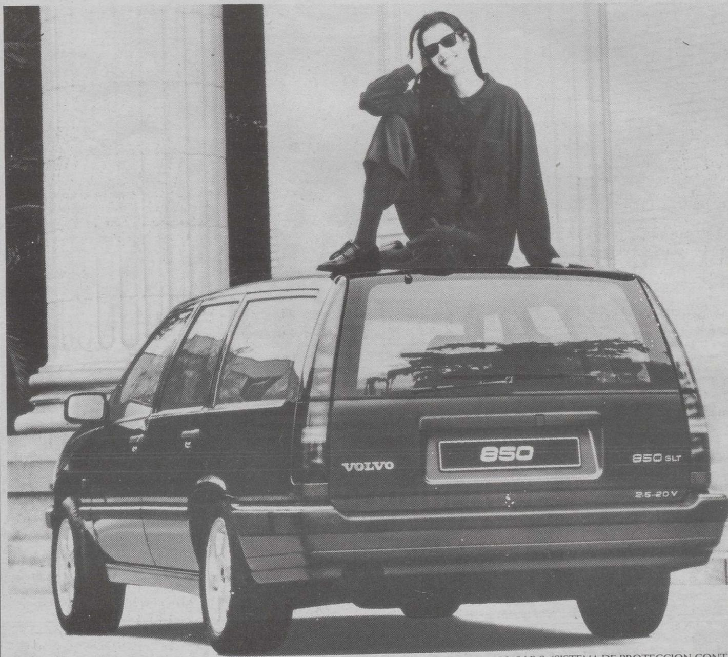
VOLVO 850 GLT. 2,5 L., 5 CILINDROS, 20 VALVULAS. 170 CV. TRACCION DELANTERA, ABS, S.I.P.S. (SISTEMA DE PROTECCION CONTRA IMPACTOS LATERALES), 0 A 100 KM/H. EN 9,5 SEGUNDOS, SUSPENSION DELTA LINK.
