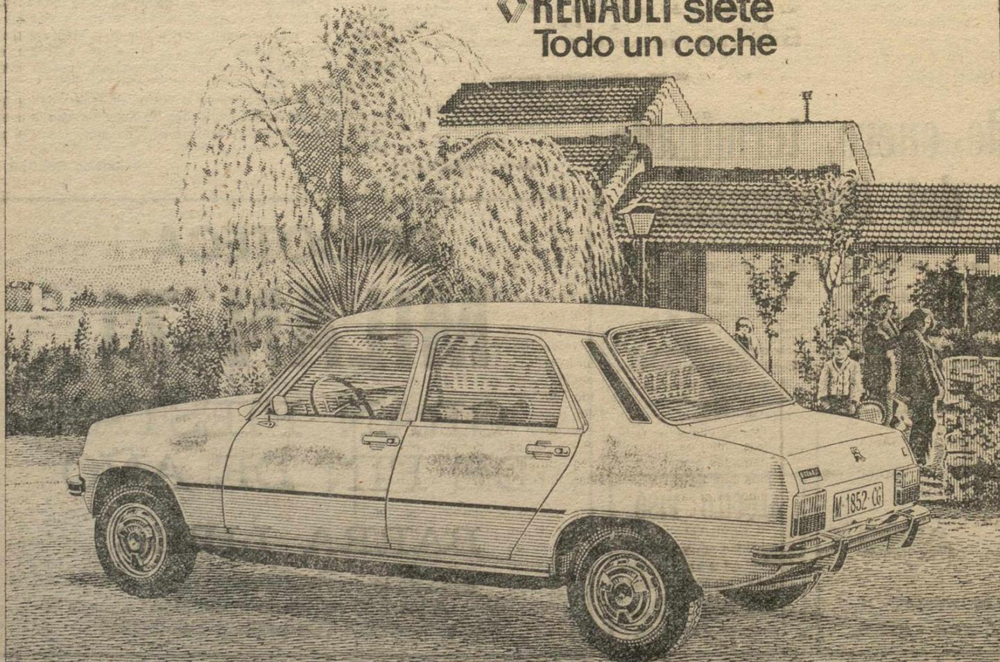
Motor Renault 1.037 cm<sup>3</sup> Tracción delantera. Suspensión por barras de torsión. Cuatro puertas.
