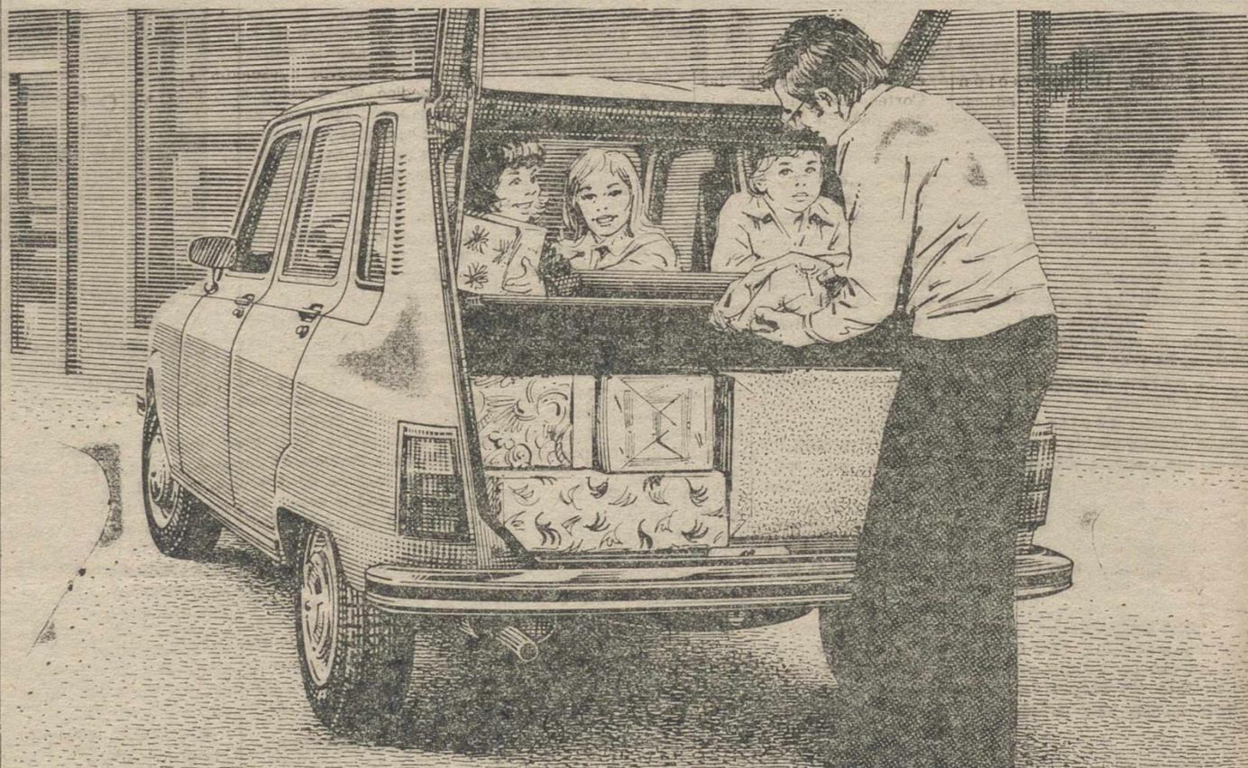
Maletero ampliable desde 380 dm<sup>3</sup> hasta 1.190 dm<sup>3</sup>.
