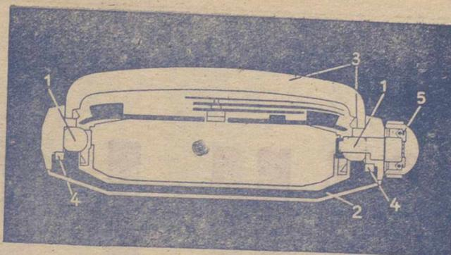
1.- JUNTA ELASTICA. 3.- CRISTAL ARMADO.
