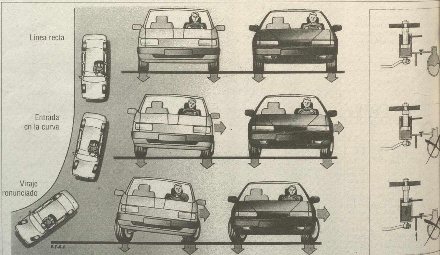
Comparación entre el comportamiento de un coche normal (izquierda) y el de un Activa (derecha); a la derecha, las válvulas que regulan la suspensión.
