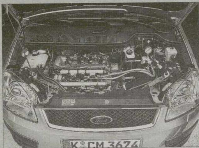
COMBUSTIBLE ALTERNATIVO. Motor de hidrógeno del C-MAX.
