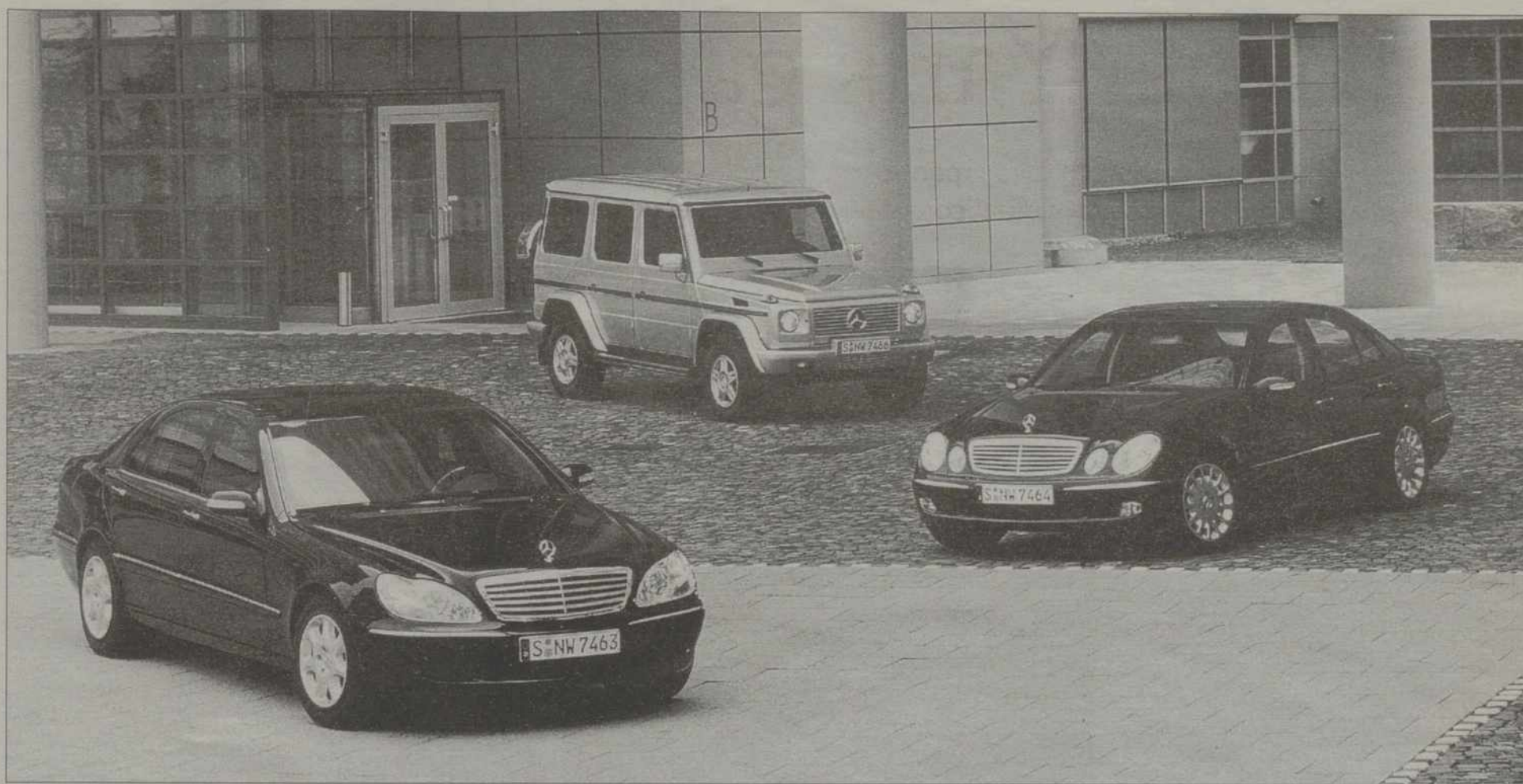
Los S 500 y S600 reciben el nivel de protección alto o superior. Los E320 y E 500 cuentan con la protección alta. Los todoterrenos G 500 son blindados con el nivel superior B6 ó B7.
