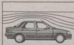
COEFICIENTE AERODINÁMICO DE 0,33
