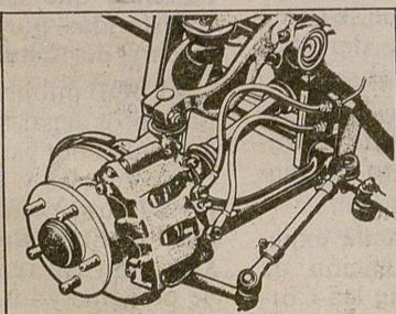
**Seguridad Mercedes.** Frenos de disco auto-ventilados. Doble circuito. Regulación de frenada en función de la carga. Suspensión independiente a las cuatro ruedas. Tracción delantera y transmisión por junta homocinética.
