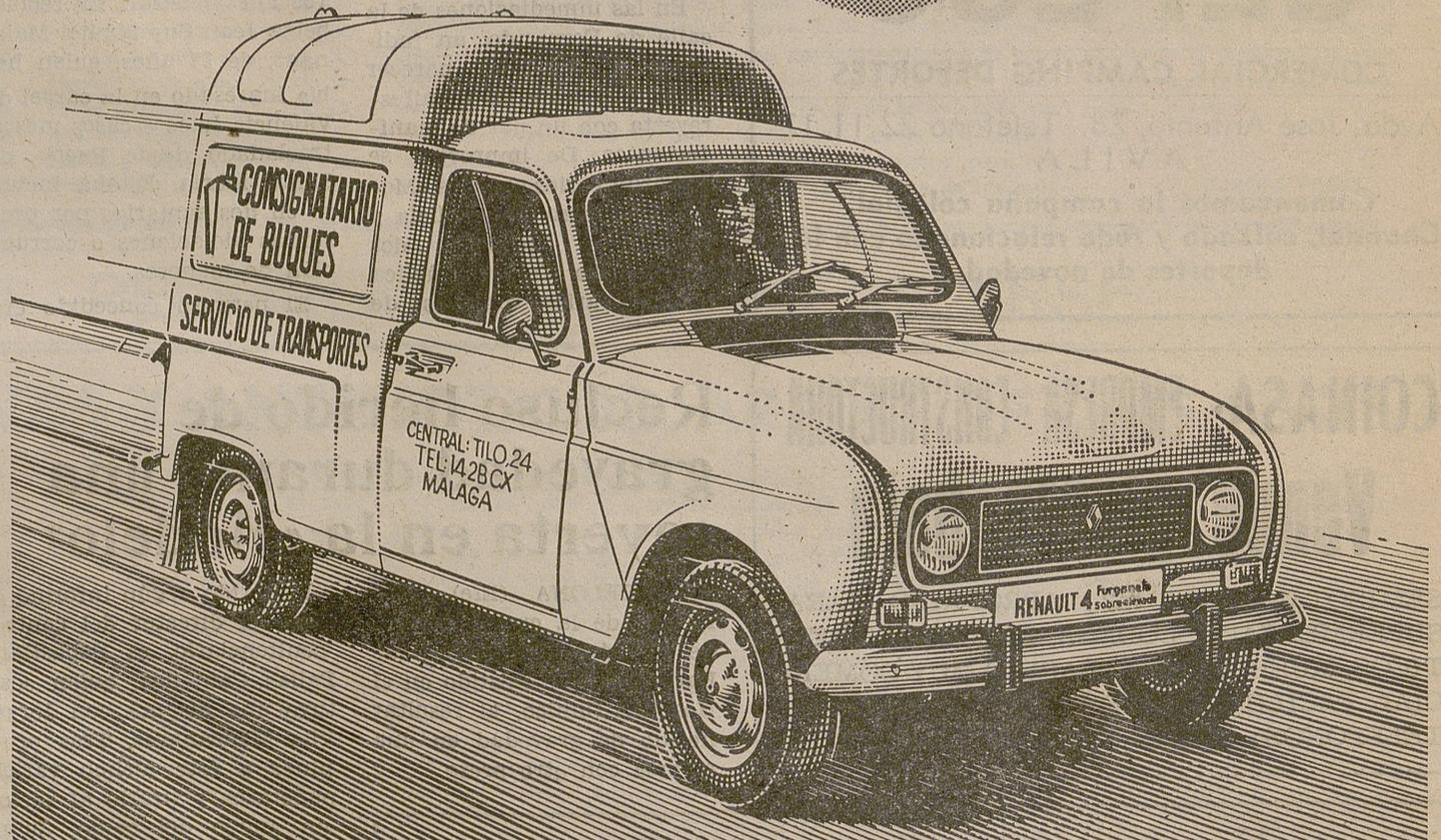
Tracción delantera, suelo plano y suspensión por barras de torsión
