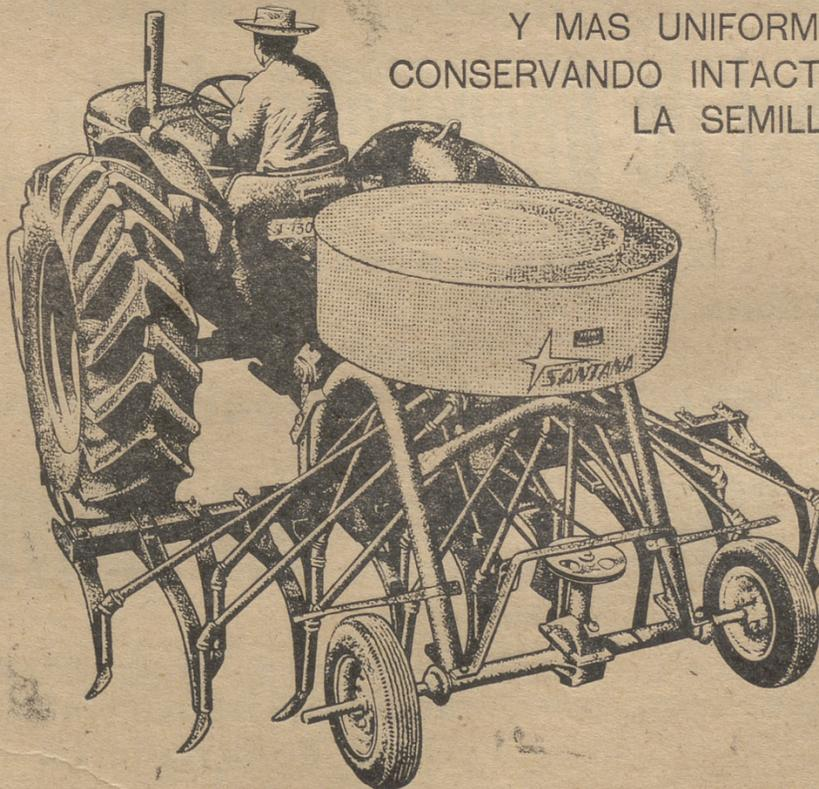
El sistema centrífugo de la sembradora SANTANA permite que la semilla se deposite uniformemente asegurando una perfecta distribución.
