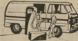
Sólo consume 9,8 litros cada 100 kms., posee mezclador automático de aceite, engrase automático, su motor DKW, 2 tiempos, 3 cilindros, desarrolla una velocidad de 100 kms. hora y sube pendientes de hasta el 26 %.
