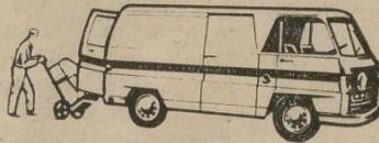
Carga 1.000 kgs. y ofrece un volumen de 6,6 m.<sup>3</sup> que puede aprovecharse totalmente para carga útil, incluso para la de productos ligeros.
