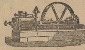
Máquina de vapor fija horizontal
