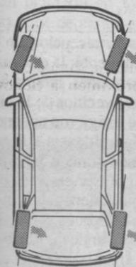
El tren trasero autodireccional es un gran avance para ganar en estabilidad en los terrenos virados. Para ganar en seguridad.
