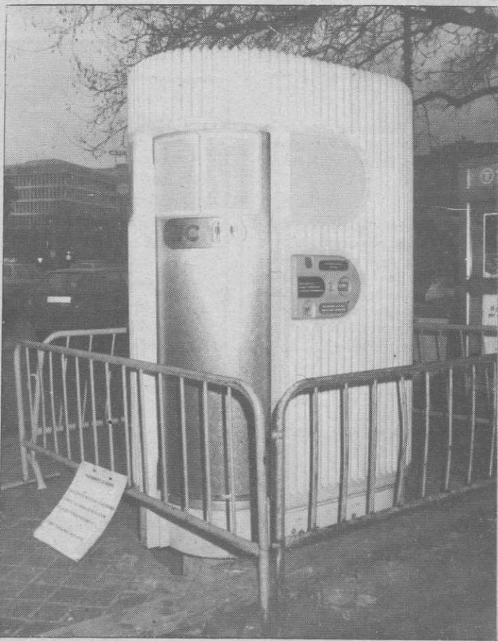
Madrid.—Uno de los nuevos urinarios públicos que se están instalando en Madrid. Se trata de una cabina individual, cuya puerta se abre de forma electrónica al introducirse una moneda.—(Efe).
