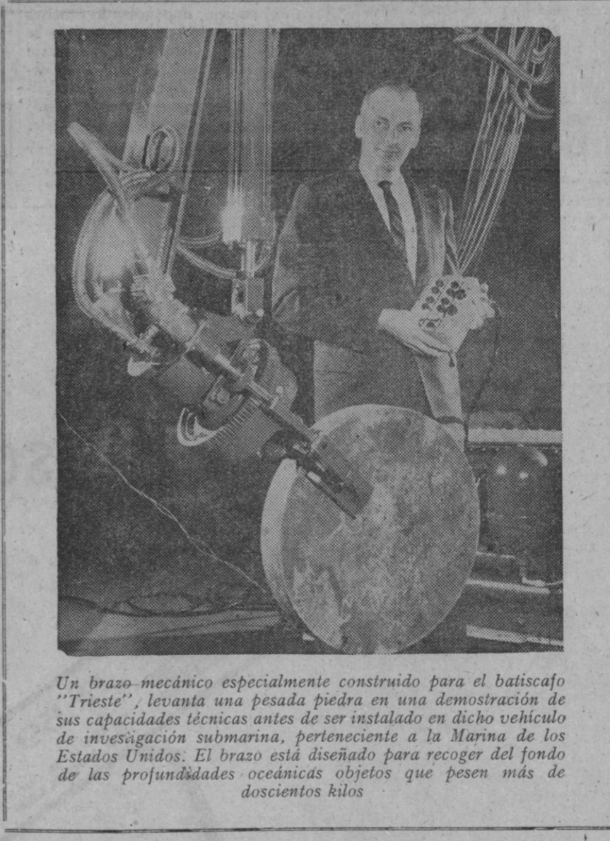
Un brazo mecánico especialmente construido para el batiscafo "Trieste", levanta una pesada piedra en una demostración de sus capacidades técnicas antes de ser instalado en dicho vehículo de investigación submarina, perteneciente a la Marina de los Estados Unidos. El brazo está diseñado para recoger del fondo de las profundidades oceánicas objetos que pesen más de doscientos kilos
