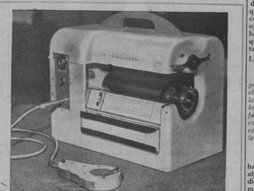
Aquí tienen ustedes un dictáfono que funciona con sólo oprimir un botón, pudiendo repetir el dictado desde cualquier punto del texto. Es de amplificación eléctrica y repite todos los tonos de voz con absoluta fidelidad. Funciona con corriente alterna y no gasta más energía que la que pueda consumir una lámpara normal
