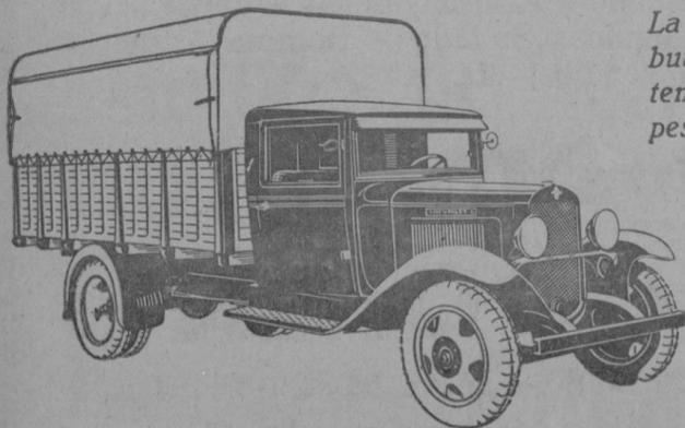
Carrocería tipo militar. La armazón de acero embutido es sumamente resistente sin inútil aumento del peso muerto.
