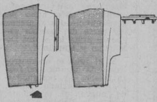
**LIMPIEZA INSTANTANEA.** En la Nueva Philishave 3 se ha incorporado un pulsador que acciona automáticamente la apertura de la cabeza afeitadora, facilitando una limpieza instantánea.
