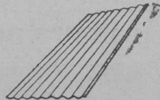
Bovedilla patentada para la construcción de techos.
