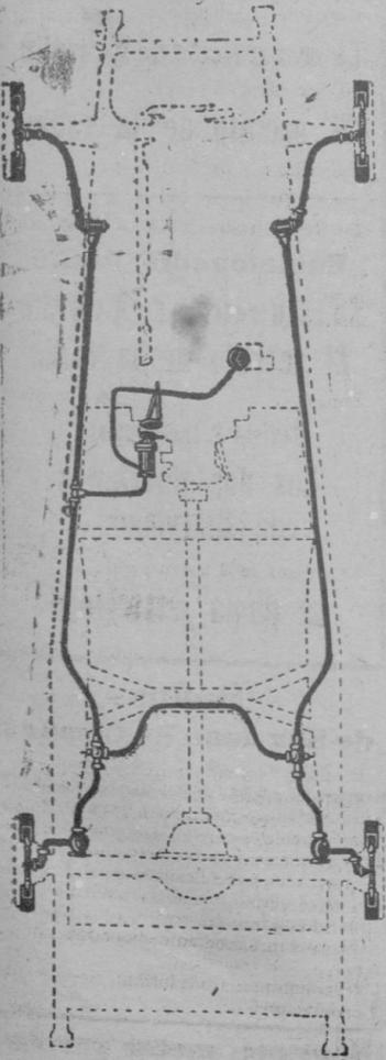
Diseño de un chasis Paige Jewett de frenos hidráulicos 4 ruedas, ataque directo sin conexiones ni mardos, careciendo en absoluto de puntos que deban engrasarse
