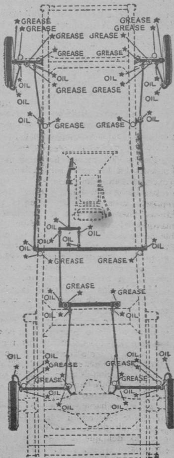
Diseño de un chasis con frenos a las 4 ruedas de mandos mecánicos y los puntos que deben engrasarse.
