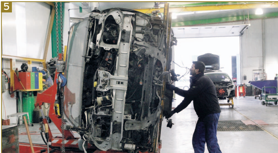
3. Etiquetador de piezas para la venta online. 4. Planta de desmontaje de vehículos. 5. Elevador-volteador de vehículos. 6. Maquinaria recicladora de vehículos. / FOTOS NEREA LLORENTE
