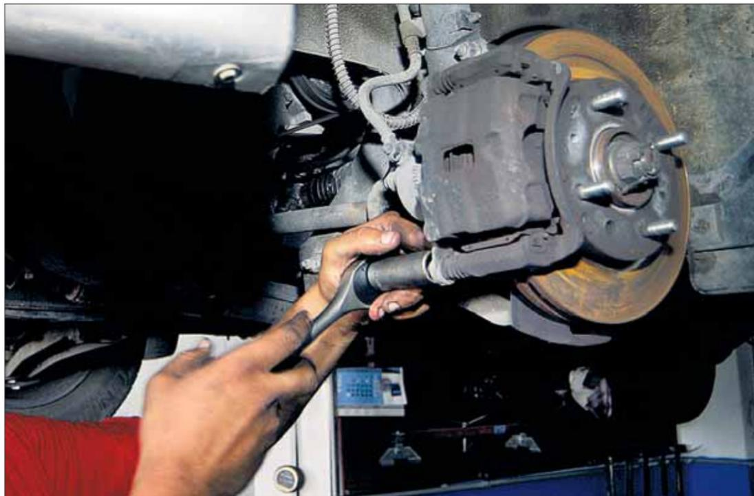
Un mecánico, realizando trabajos de ajuste en el sistema de frenado de un turismo. / KAMARERO
