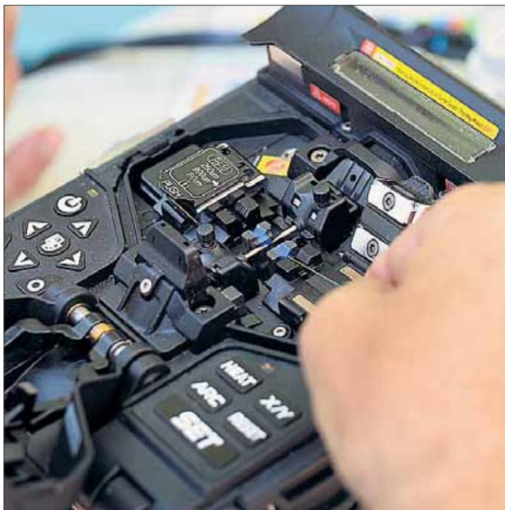
El proceso de fusión de la fibra debe realizar por métodos mecánicos. / E. A.
