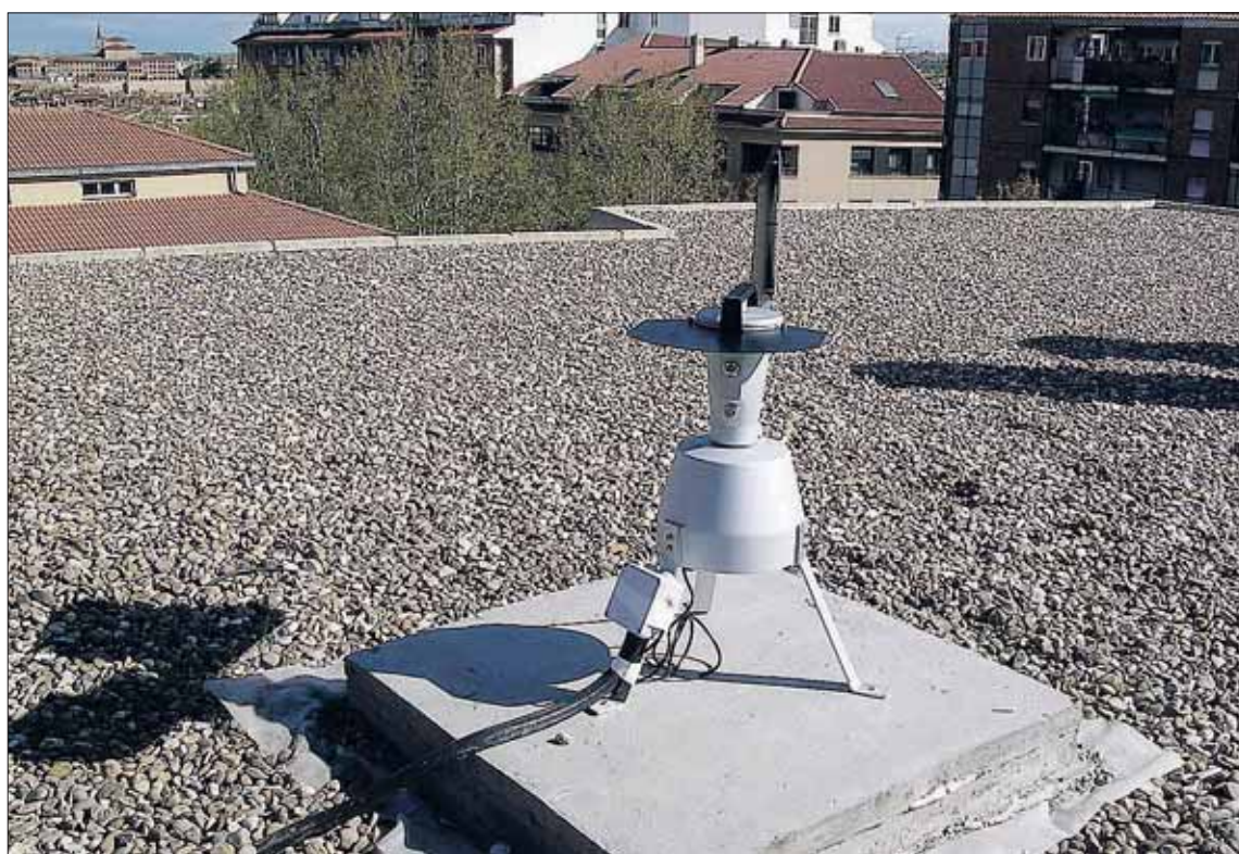
Estación de captación y medición de los niveles de concentración de polen, instalada en la ciudad de Segovia. / E. A.
