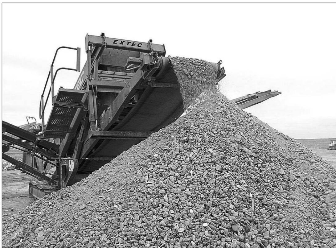
La última fase del proceso, triturar y cribar el material de derribo para obtener árido reciclado.
