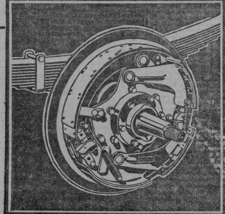
Sección de un freno delantero
