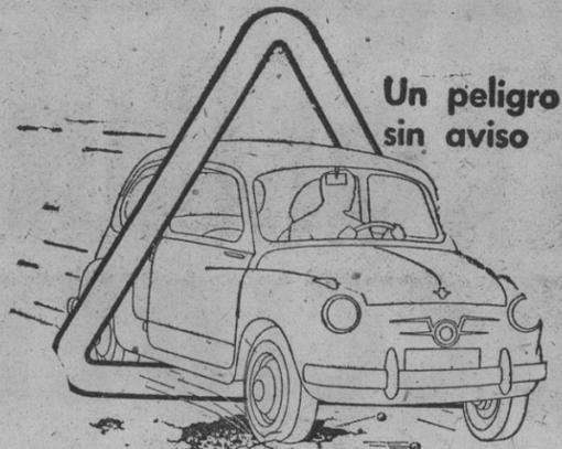
Los impactos en carreteras —un bache, un bordillo, una piedra afilada— son riesgo frecuente y causa directa de roturas en el tejido del neumático, cuyas capas se someten a un esfuerzo extremadamente localizado y rápido. El neumático queda debilitado en dicho punto y su fallo puede surgir de improviso.
