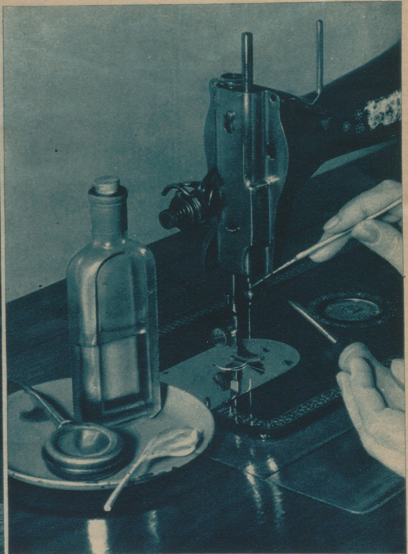
Limpieza de la máquina de coser con pluma de ave; engrasarla con un fino pincel
