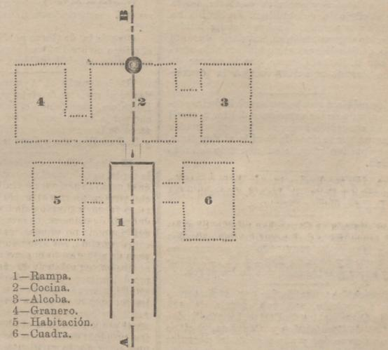
PLANO Y SECCION LONGITUDINAL DE UN SILO
