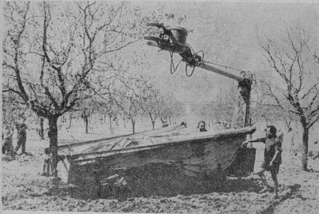
LA MARAVILLOSA "SR" ITALIANA CON EL "PARAGUAS" PARA RECOGER EL FRUTO CERRADO. OBSERVESE LA ALTURA A QUE PUEDE LLEGAR LA ABRAZADERA QUE SUJETA EL ARBOL EN CUALQUIER POSICION. — (Foto TERRADES).
