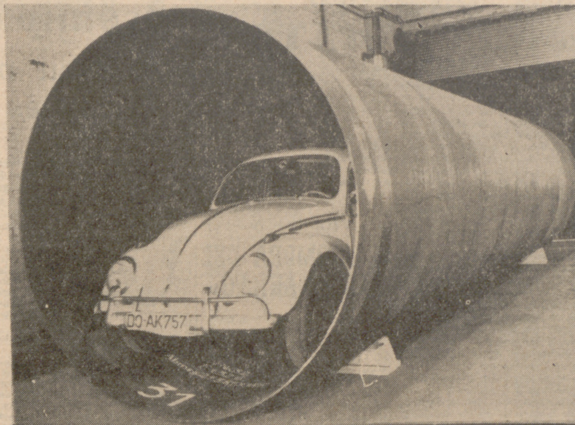
DORTMUND (República Federal Alemana).—Tubos de acero del tamaño gigantesco de dos metros y medio de diámetro, por los cuales puede pasar holgadamente un "Volkswagen", se podían fabricar hasta ahora sólo individualmente. Después de la construcción de una taladradora de broca espiral completamente automática, de un coste de dos millones y medio de marcos, la firma "Hoesch", en Dortmund (República Federal de Alemania), suministra semejantes tubos gigantes, ahora en serie, como producto de un proceso de fabricación continua. Los primeros de estos tubos de acero en fleje, soldados en espiral, y de un espesor de pared de 13 milímetros, estuvieron destinados para una refinería inglesa. No obstante, es posible transformar la instalación en cualquier momento para la producción de tubos de chapas gruesas de hasta 23 milímetros de espesor. Con ello la empresa espera que, una vez concluidas las negociaciones germano-soviéticas sobre el suministro de tubos grandes, consiga una participación esencial en el negocio con la Unión Soviética. Indudablemente, estos supertubos serán particularmente apropiados para la proyectada cañería de gas natural desde Siberia hasta la República Federal de Alemania.
