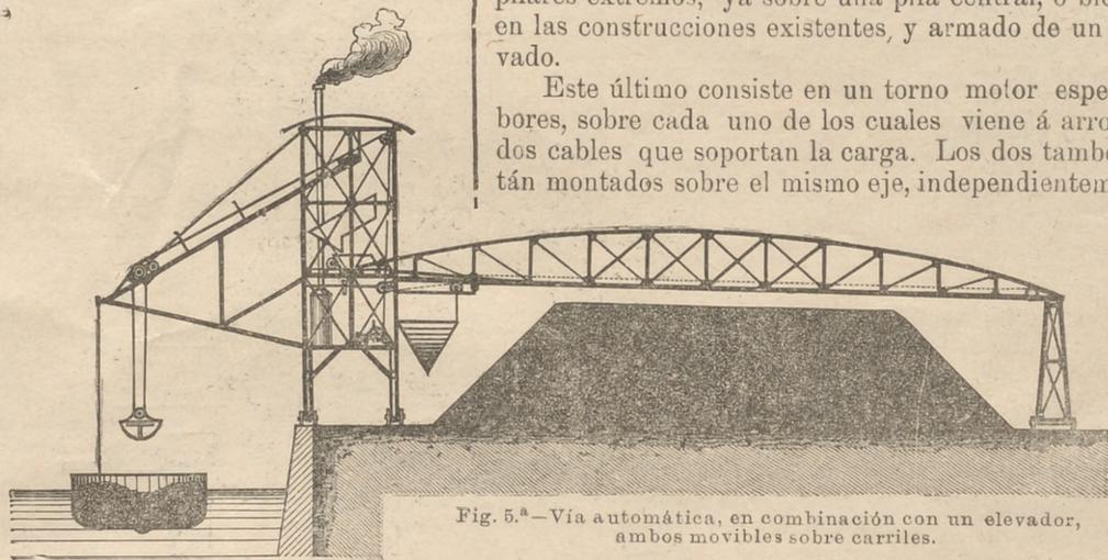
Fig. 5.<sup>a</sup>—Vía automática, en combinación con un elevador, ambos móviles sobre carriles.
