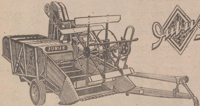
Accionada por tractor con 1,480 metros anchura de corte
