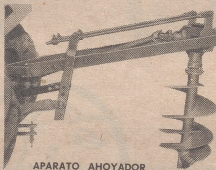
APARATO AHOYADOR Hace hoyos de 20 a 60 cm. de diámetro por 60 a 100 cm. de profundidad
