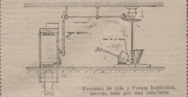
Esquema de rulo y Prensa hidráulica, movido todo por una caballería
