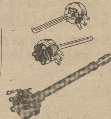
Fig. 25.—Resistencias variables y potenciómetro.
