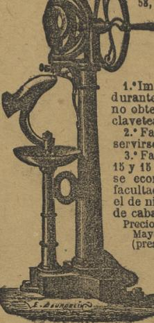
Llamo particularmente la atención sobre el inmenso perfeccionamiento dado á mi Máquina de Clavetear y que consiste en un resorte automático del que resultan las ventajas siguientes:
