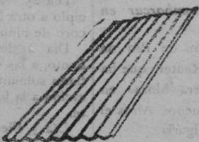
Bovedillas patentadas para la construcción de techos.
