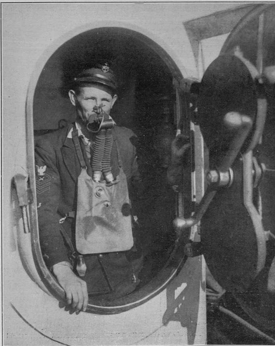
El «pulmón artificial», que completa el sistema de salvamento ideado por el teniente Momsen, de la marina de guerra norteamericana
