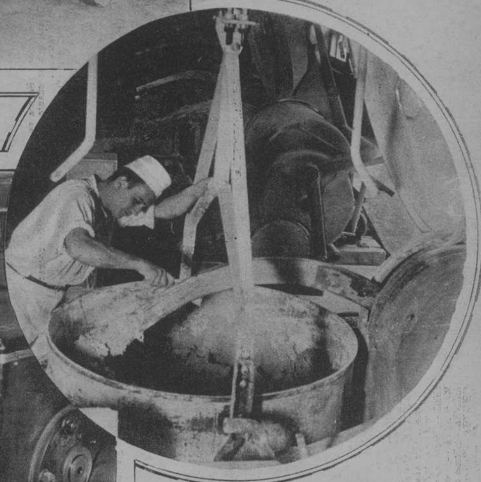
He aquí la máquina para amasar, que suprime la fatigosa gestión del brazo humano
