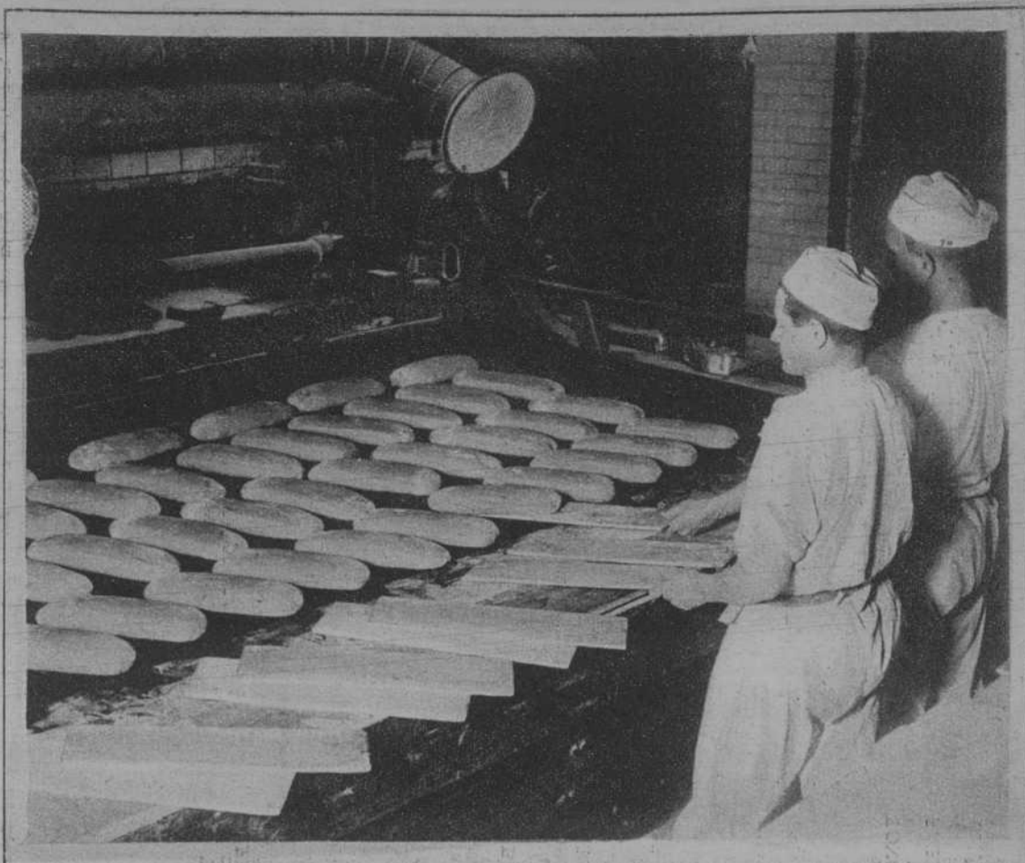
Los panes entran, crudos, por una parte del horno, y salen por la otra, perfectamente cocidos, olorosos y relucientes
